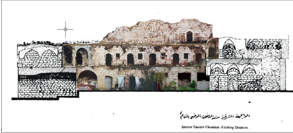
شكل (16:4): الواجهة الشرقية من الداخل/قبل الترميم.
